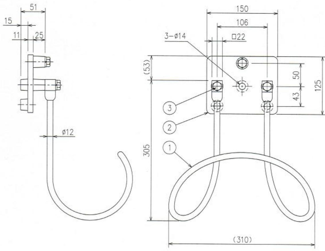
\* プレート取付け用に穴が3箇所開いています。
